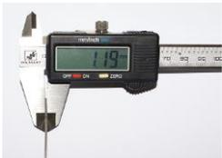
Mesure du diamètre du fil à l'aide d'un pied à coulisse
