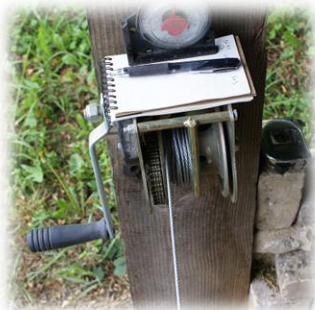
Treuil mécanique permettant de mettre le câble en tension
