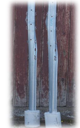
Comparaison de déformation/torsion de 2 modèles de piquets profilés.
