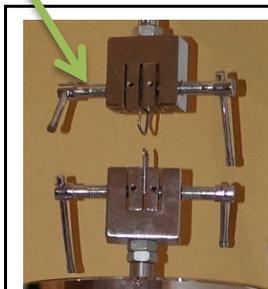
Mise en place d'un dispositif spécialement conçu pour simuler les efforts de tension des agrafes sur les fils releveurs dans une vigne.
