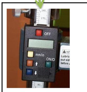
Mesure du déplacement faite à l'aide de la règle millimétrique et du lecture électronique au 1/100° de mm
