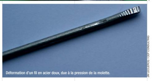
déforme. Dans le cas des tendeurs à mâchoires, le rapport (résistance du rabouteur/résistance du fil) est supérieur à 0,9, sauf dans le cas du câble d'amarrage où le rapport est de 0,8. Le différentiel est probablement dû à la surface de contact plus importante entre le fil et les mâchoires », conclut Jean-Marie Leclercq.
