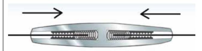
Le rabouteur à mâchoire emprisonne le fil. Il est doté d'une butée au milieu et d'un système antiretour. SOURCE IDELYS
